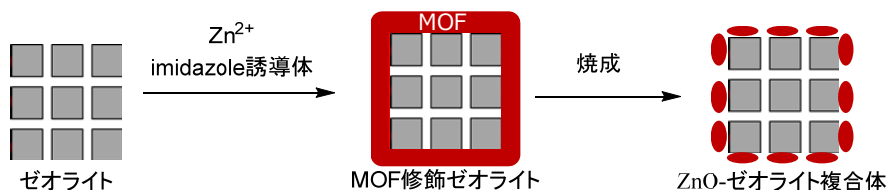
図3. ゼオライトのMOF修飾を利用したZnO-ゼオライト複合体の合成
